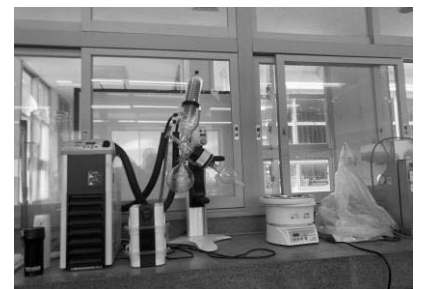
エバポレーター
