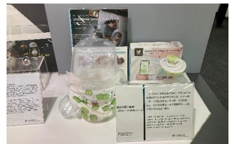
赤ちゃんの心拍数、呼吸数、体温、異物混入、睡眠段階をモニタリングできるウェアラブル健康デバイス
